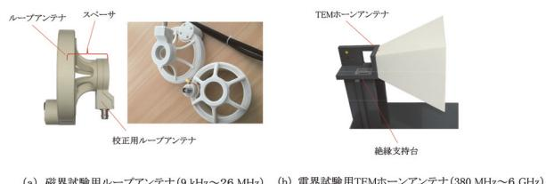
図12 近接放射電磁界イミュニティ試験に使用するアンテナの例
